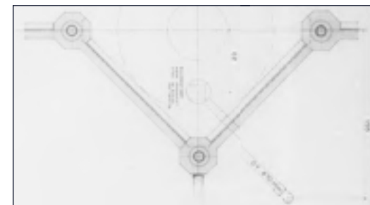
Afb. 3.19 Stalen kolommen op verdieping
