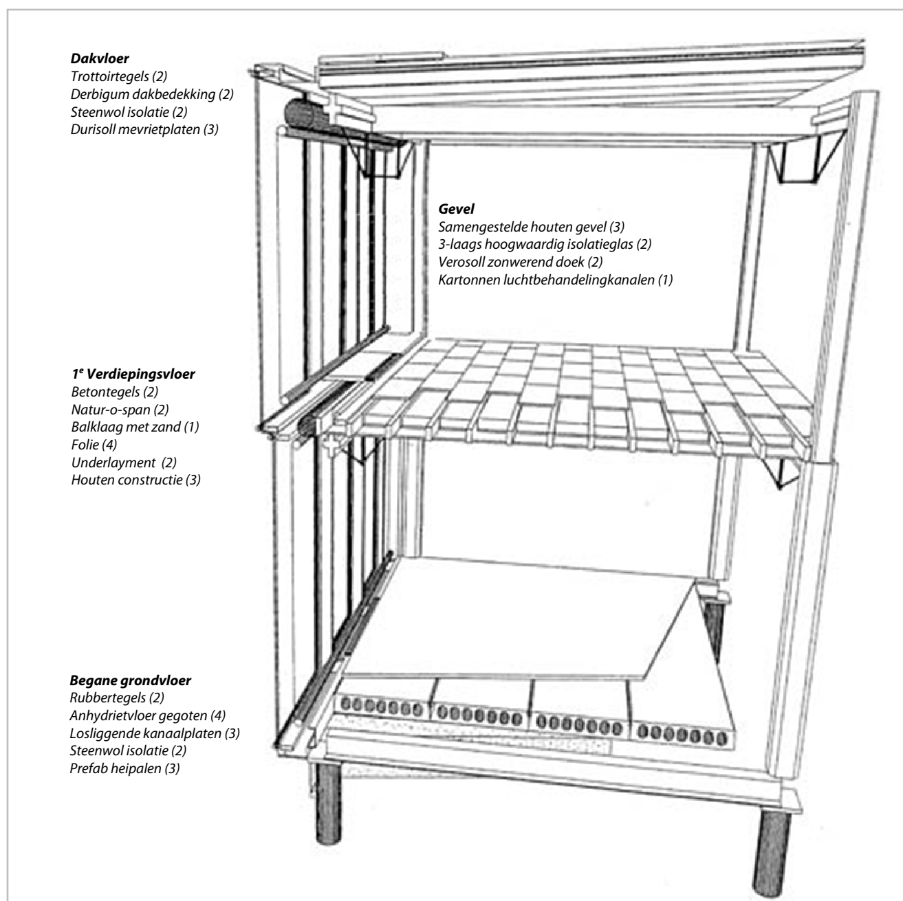
Fig. 2.9: Perspectief doorsnede XX kantoor (De nummers refereren naar de prioriteiten genoemd in de tekst)
